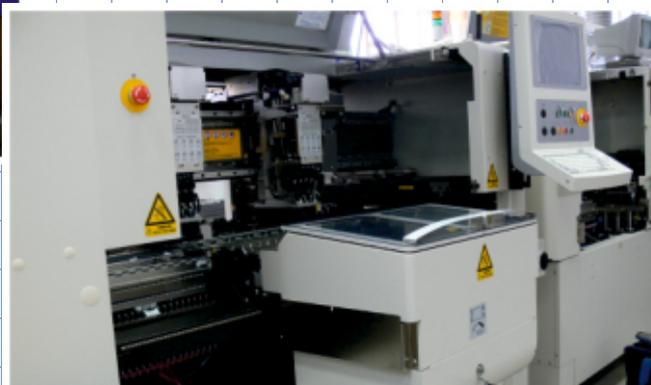
Сборочно-монтажное производство узлов, приборов, и систем оснащено автоматизированными средствами и линией монтажа элементов на печатные платы по технологии поверхностного монтажа с встроенной системой автоматического оптического контроля, стендами функционального контроля, промышленной системой рентгеноскопии X T V-160 фирмы Nikon и системами струйной отмычки Öko 2000 с контролем качества чистоты отмычки и сушки.
