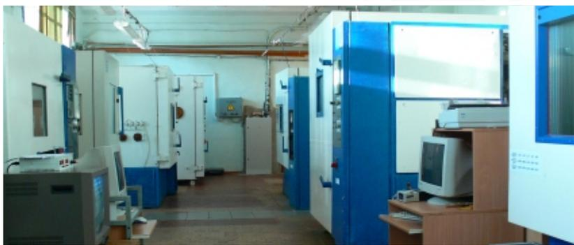
Механические испытания: на вибропрочность и виброустойчивость к синусоидальной вибрации с частотой колебаний от 10 Гц до 400 Гц и ускорением до 430 м/с<sup>2</sup>; на ударную прочность от 10 до 180 ударов в минуту и ускорением до 1000 м/с<sup>2</sup> (транспортная тряска).
