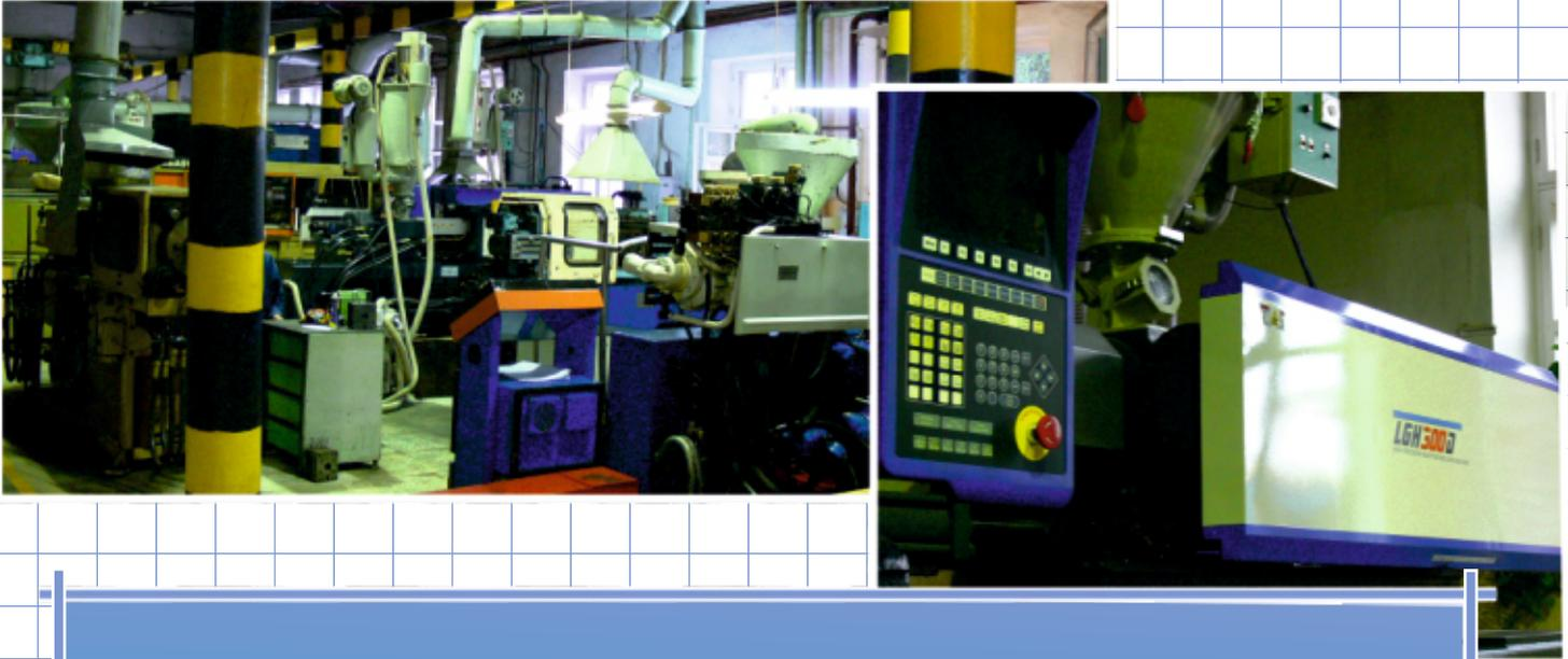
Участок по переработке пластмасс оснащён (ТПА) термопластавтоматами с объемом впрыска от  $94\text{см}^2$  до  $736\text{см}^2$  и усилием запираения от 25 тс до 300 тс позволяющими изготавливать изделия методом литья под давлением из различных термопластичных материалов ; полистиролов, поликарбонатов, пластиков АБС, полиэтиленов, квартопренов, а современные суперконцентраты окрашивают материал в любой желаемый цвет.
