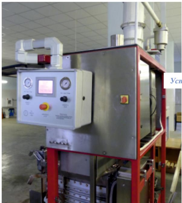
Установка горячего лужения PENTA-450
