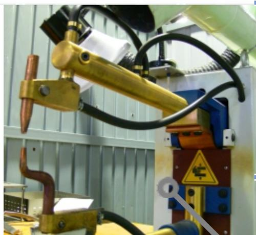
Участок сварки деталей оснащён аппаратами контактно-точечной, аргодуговой, электродуговой в среде  $\text{CO}_2$ , и конденсаторной сварки.
