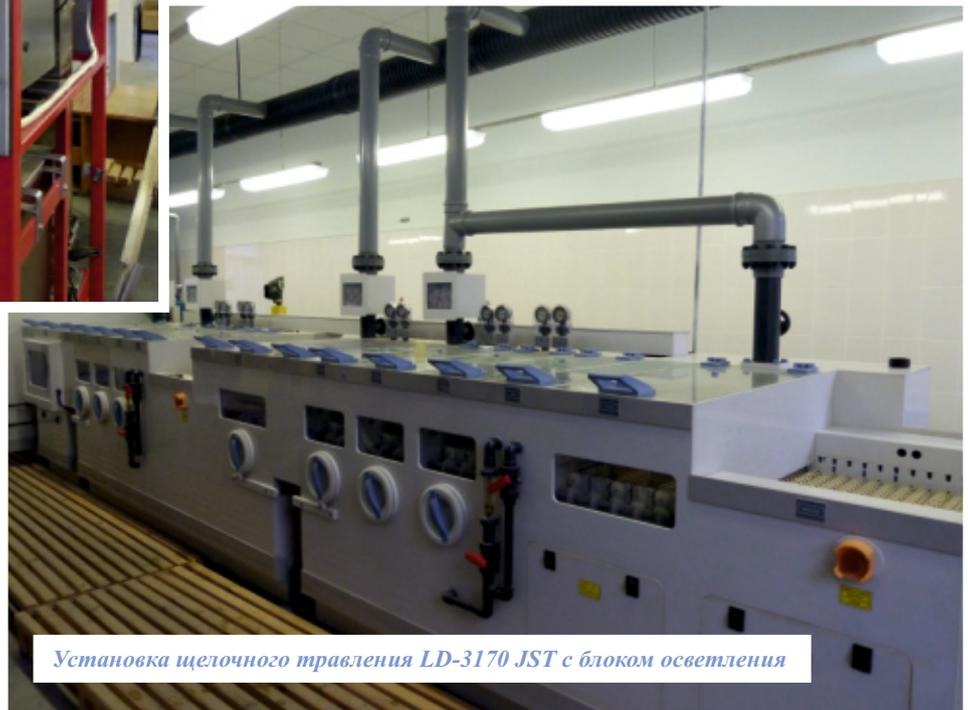
Установка щелочного травления LD-3170 JST с блоком освещения
